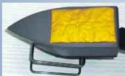
Fig. 3C Test de température du fer à 150 °C
