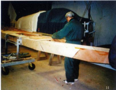
Photo 11 : Aile en construction sur son support mobile.
