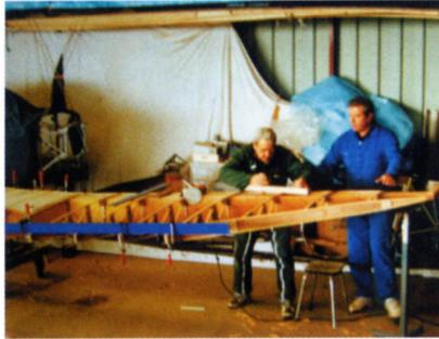
Photo 12 : Ajustage des nervures avant coffrage des bords d'attaque.
