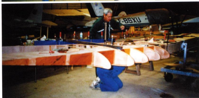
Photos 8 & 9 : Montage des nervures sur le longeron.
